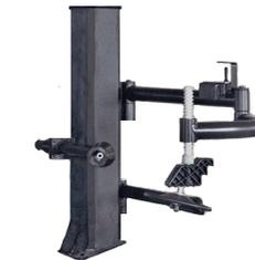
Вспомогательное устройство для работы с низкопрофильными шинами РВ-1
